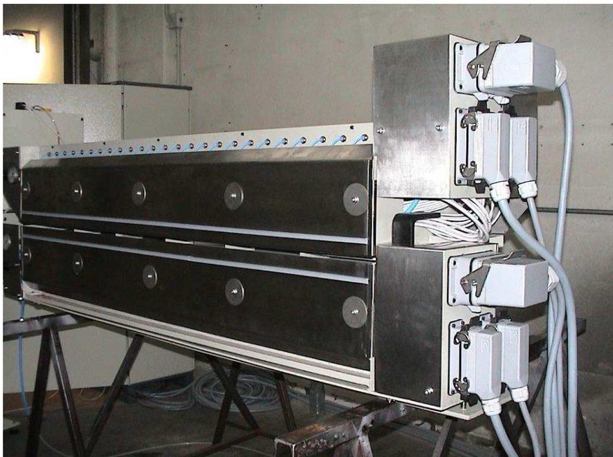
Размер механизмов в ширине - от 1000 до 2500 мм, в глубине от 200 до 300 мм, 100 распылительных клапанов.
