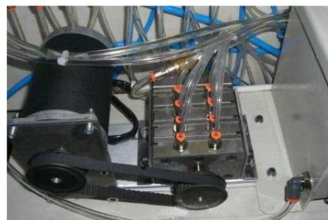
Пулверизация управляется с помощью чрезвычайно точной системы сокращения воздуха, позволяющей постоянное распределение жидкости к распылительным клапанам, при давлении от 0,1 до 1,0 бар.
