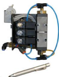
Распылительный бокс оснащен автоматической системой подачи воздуха, сдерживающей от потерь и позволяющей более легкое введение металла.
