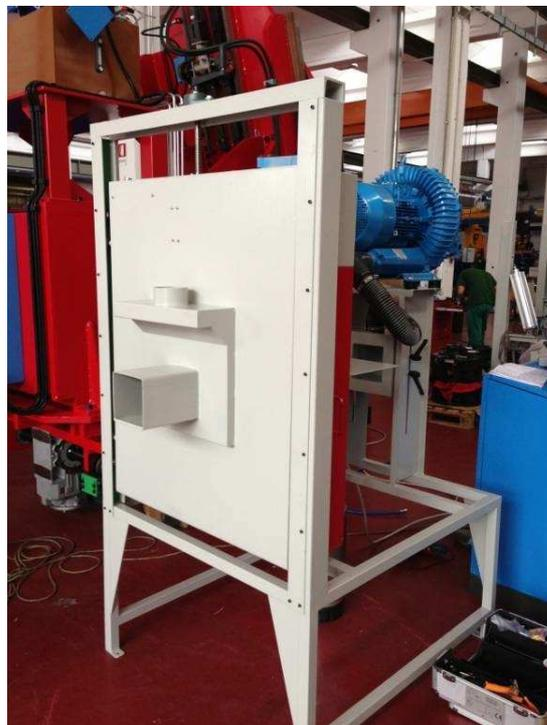
Коробка имеет С-образную систему внутренней поддержки, установленную на рельсах, для обеспечения бокового извлечения распылительных клапанов и более легкого позиционирования и обслуживания клапанов.
